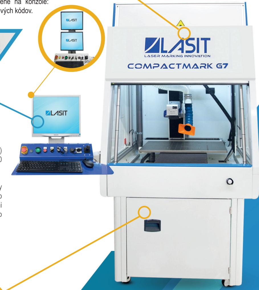
Je možné do neho zabudovať lasery, motory, skenery a počítače, ktoré sú ľahko prístupné a jednoducho prepojené s niekoľkými káblami s nezameniteľnými konektormi. Akúkoľvek poruchu je možné rýchlo opraviť bez potreby špecializovaných technikov.
